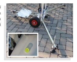
Kangur-Lift è utile in tutti i <u>luoghi inaccessibili da veicoli a motore</u>, ma in cui è necessario avere scansioni a diverse altezze, fino ad un massimo di 6,00 mt, eliminando ombre e ostacoli, come:
